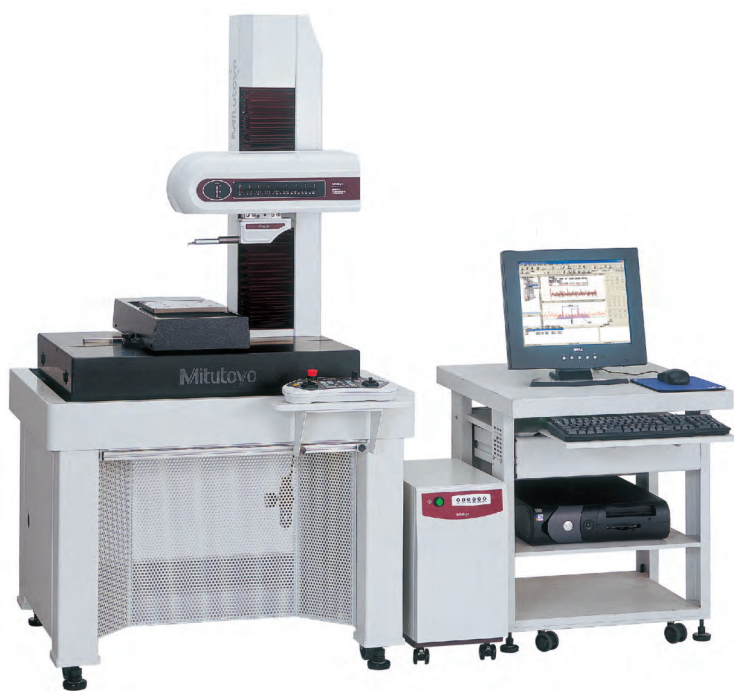
SV-3000CNC с персональным компьютером и программным обеспечением
