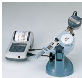
Пример применения: с цифровым индикатором
