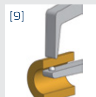
Резец R 0,4 мм Шарик Ø 1,5 мм
