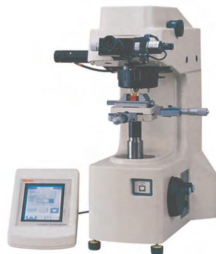
HM-112 Цифровой дисплей и функция статистического расчета
