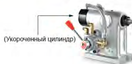
▲ HTTJ-320 (установлен гидравлический клапан ручного переключения)
