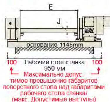
▲ Рисунок ④ : Основание поворотного стола больше габаритов рабочего стола станка
